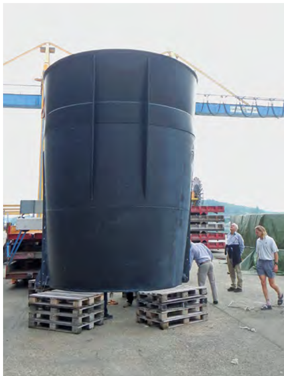
Seitenansicht des Diffusors der Stromboje. Im Wasser liegend ist der Diffusor etwa 3 Meter hoch.
