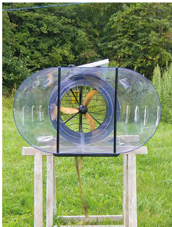
Ansicht der Stromboje von hinten gegen die Strömungsrichtung des Wassers. Gut erkennbar ist die abgeplattete Form des Diffusors.
