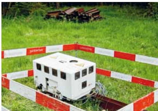
Ergänzung der Turmmessung durch optische Messung mit LIDAR-Gerät
